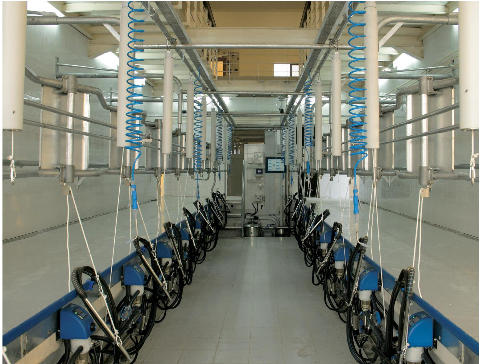
30° ヘリンボーンパーラーの組み立ては簡単ですが、乳牛と搾乳者が最善を尽くせるように、細部にまで細心の注意を払い徹底的に考え抜いて製作しております。ピットエッジはパーラーの統合された一部分であり、乳牛は二次蹄を刺激されることなくその近くに立つことができます。2つのジグザグパイプは乳牛の体に沿っているので、搾乳者は乳房の直ぐ近くに接近することができます。
