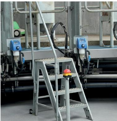
ジグザケピットエッジは、搾乳者が乳牛に接近できるので、搾乳準備と装着作業が簡単にできます。また、乳牛の背後に糞尿プレートを設置することも可能です。
