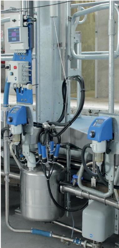
ストールポジションにはIDCとQuickStartが装備されていますので、牛乳の下で搾乳ユニットを取ったり、ボタンを押すかどうかを自由に選べます。
