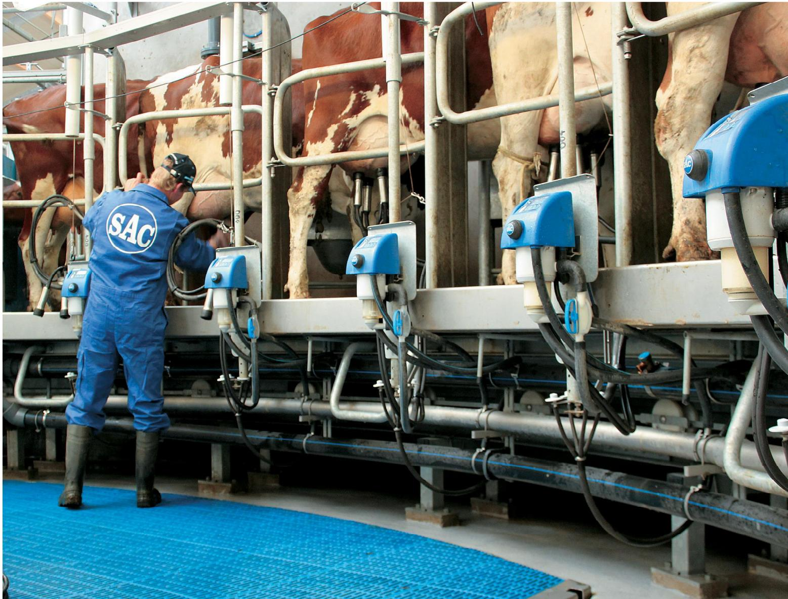
SACの内部ロータリーは、防錆ジグザグピットエッジで作られているので、乳牛は背中をまっすぐにして、搾乳者の近くに自由に立つことができます。ホースガイドと高さの調整により、乳牛と搾乳者の両方に最適な条件が調整できます。SACQuickStartを使うと、搾乳ユニットを乳房の下を持って行ったときに自動的に搾乳プロセスを開始します。
