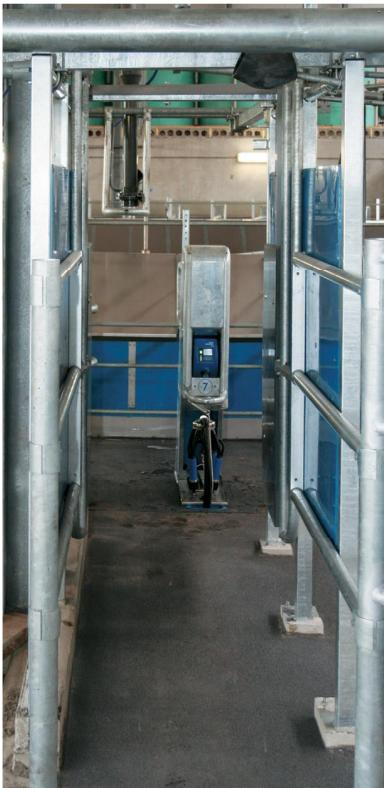
高さ90cm、距離75cmのガイドパイプを備えた3メートルの長さの入口は、ストレスのない素早い乳牛の入場を保証します。入口ゲートプロテクションにより乳牛が出入る時に、乳牛を保護します。
