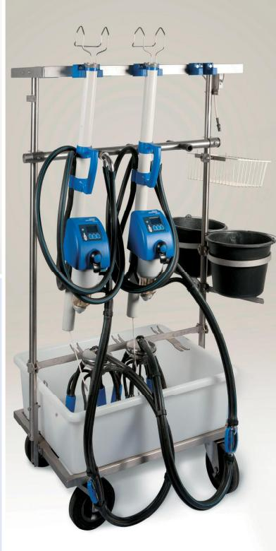
IDC T レールダブル、大型ディスプレイ、バッテリー駆動式(ケーブル無し)、ミルクフロー式離脱、迅速かつ効果的な搾乳、最小限のメンテナンス、あらゆるタイプのレールプラントに適しています(メーカーに関係なく)、シングルまたは、ダブルとして利用可能です。
