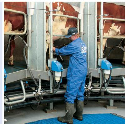
ホースガイドは、搾乳ユニットが高低両方の乳房に対して調整できるように造られています。さらに、ホースガイドを取り外すと、乳牛の足からミルクチューブが完全に取り外されます。
